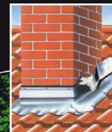
Reparação de uniões em chaminés.
